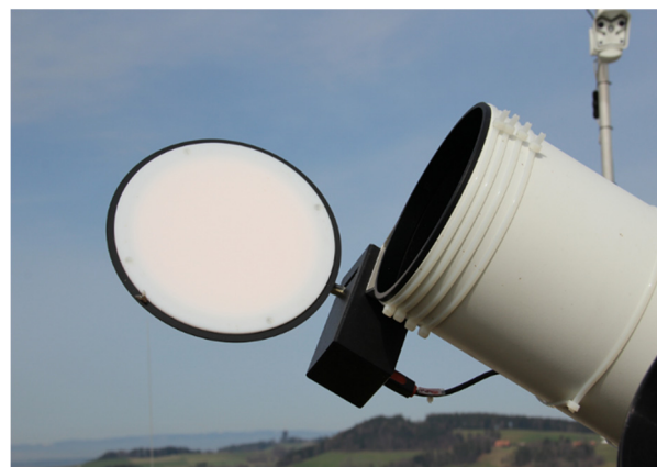
Abb. 6: Der geöffnete Flip-Flat mit der Leuchtfolie
