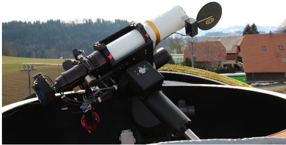
Abb. 4: Das Aufnahmeteleskop für die Exoplanetenbeobachtung in der geöffneten Kuppel des Sonnenstuhl Uecht
